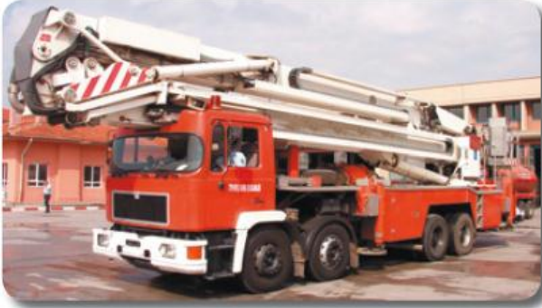
Bazı itfaiye merdivenlerinin çalışması da sıvıların basıncı iletilme prensibine dayanır.
