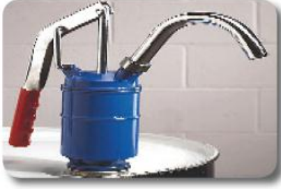
Varillerdeki sıvıları boşaltmak için basınç farkı oluşturan pompalar kullanılır.
